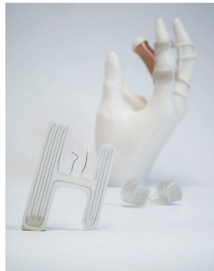
Verschiedene Elektronik-Anwendungen des Fraunhofer IWU: mit WEAM hergestellte Finger-Orthesen (links), 200-µm-Kupferdraht auf 100-µm-Folie und aufgedruckten Strukturkomponenten (S. 13 oben) und WEAM-Druckkopf mit Prozessüberwachung (S. 13 Mitte).
